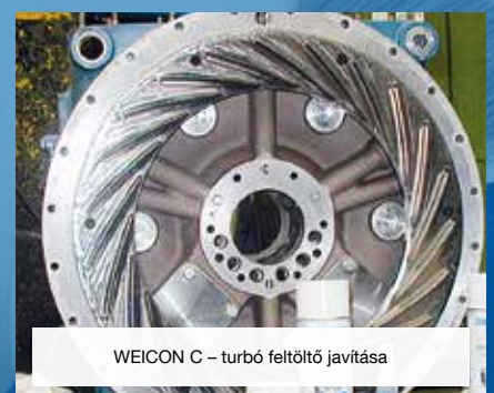
Súlyosan sérült, magasan ötvöztött acél turbina kavitációs sérülésének javítása.
