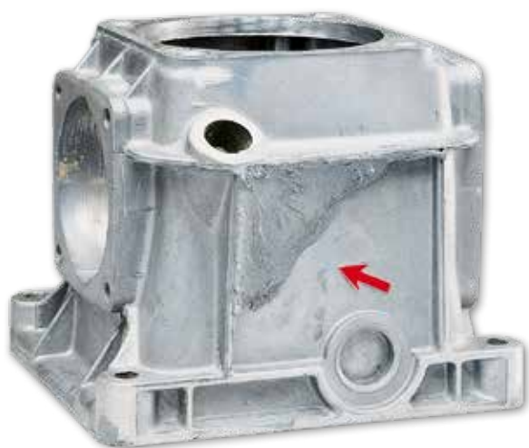
Alumínium burkolat felújítása
