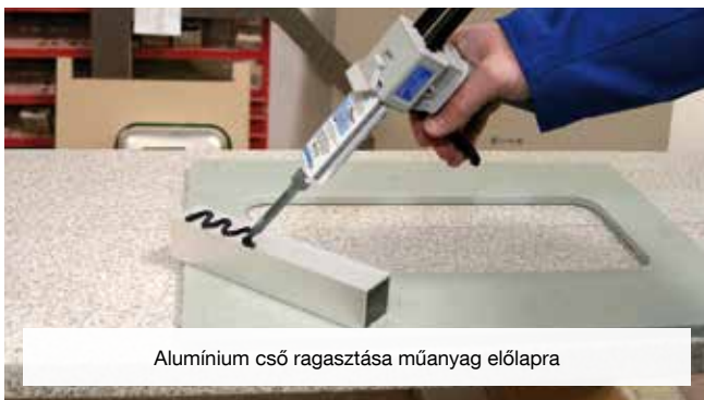
Műanyag szendvics-panelek ragasztása
